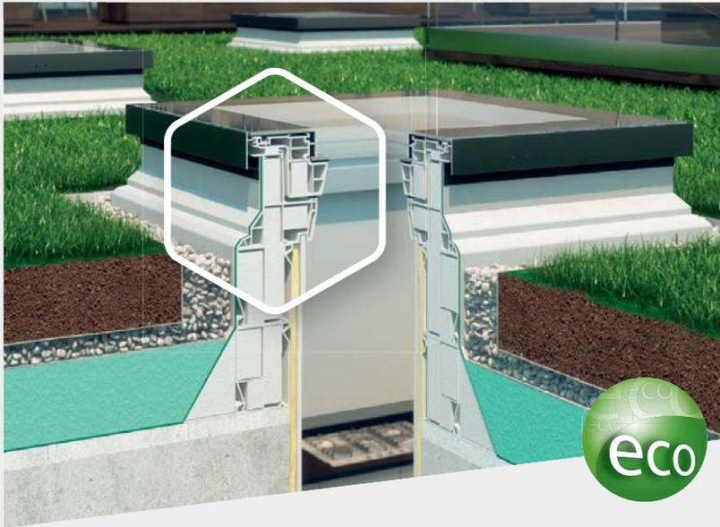
Il telaio della finestra per tetti piatti è realizzato in profili multicamera in PVC, la cui superficie interna è bianca (RAL 9010). Il materiale in cui sono realizzati i profili si caratterizza per l'alta resistenza agli acidi ed il basso assorbimento di umidità, pertanto la finestra può essere installata in qualsiasi vano.
